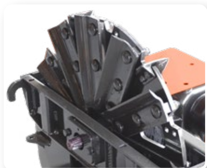
Rotor principal equipado com 12 facas e 6 lançadores de série
