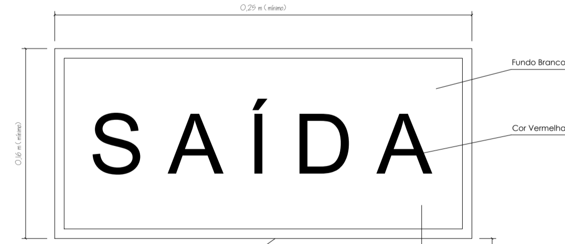
DETALHE Sinalização de Abandono S/resc (dimensões indicadas)
