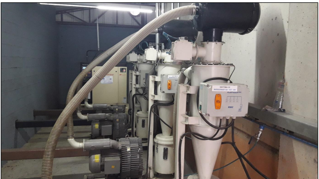
Figura 5 – Sistema de transporte a vácuo dos pellets plásticos
